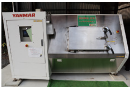
バイオコンポスター。内部の食品廃棄物や刈り芝を攪拌する部品はヤンマーの耕運機で培った技術を応用している
