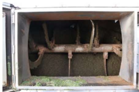
バイオコンポスター。内部の食品廃棄物や刈り芝を攪拌する部品はヤンマーの耕運機で培った技術を応用している
