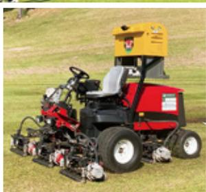
ティーチングプレイバック方式を使って自動でグリーンキーパーの動作を再現。間近で見ると迫力がある
