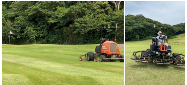
ゼブラカットのプログラムで自動走行中。操作担当者は夕方自宅で進行を確認
